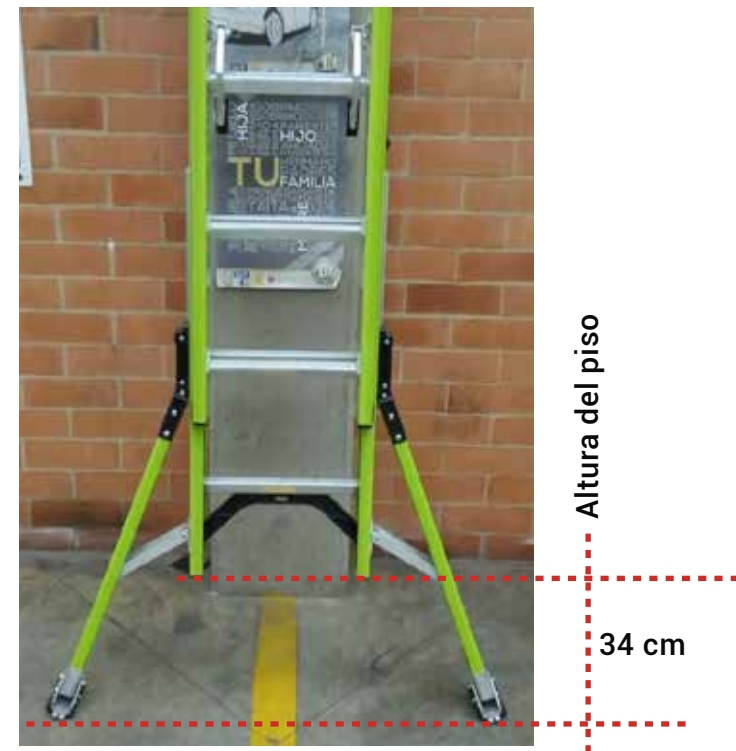
Estabilizadores totalmente abaj
