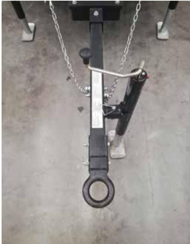
Gancho de remolque desmontable
