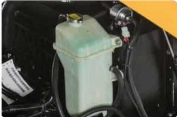
Puede llenarse fácil y rápidamente con refrigerante, y se puede observar claramente que la posición del líquido se repone cuando el refrigerante es insuficiente.
