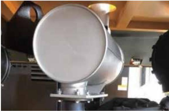
Para reducir el ruido del ventilador del motor de alta velocidad, se adopta el silenciador para absorber la vibración y aislar el sonido, de modo que la energía del sonido se pueda reflejar de regreso al lugar original para reducir el ruido
