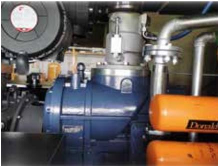
Control eléctrico (válvula solenoide, válvula de ventilación, válvula proporcional, etc.)
